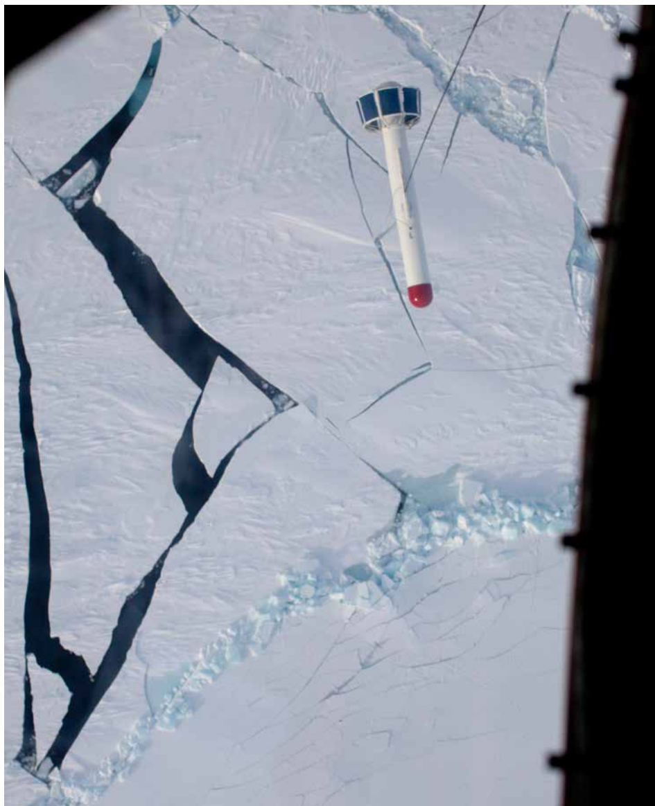
Helikopter flyr med en EM-bird hengende under. Med dette instrumentet kan det måles den samlede tykkelsen av snø og havis over avstander på flere kilometer. Det er saltholdigheten i isen og vannet under isen som måles og danner grunnlaget for tykkelsesberegningene. Foto: © Nick Cobbing, Norsk Polarinstitutt
