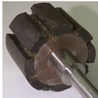
Figur 2.13: Rotor for børsteløs motor.
