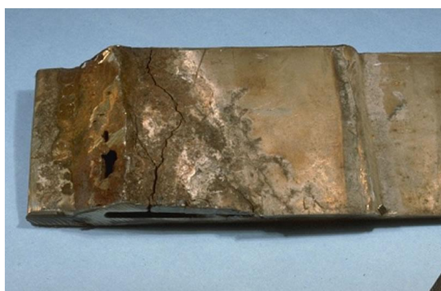
Figur 9: Stress korrosjon sprekk [19]
