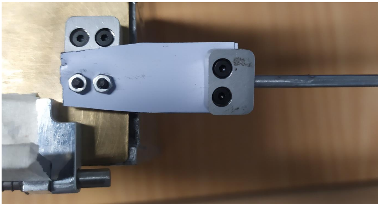
Figur 61 Montert prototyp av antenne mekanisme
