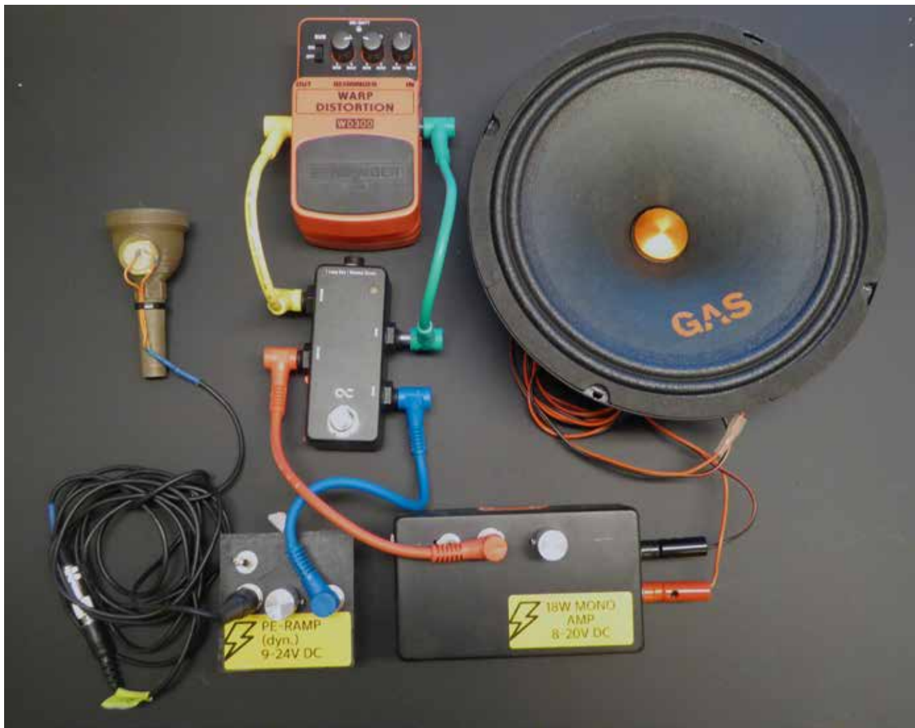
Modulbasert Thranophone med 3D-printet munnstykke i bronse compositt med piezomikrofon.
